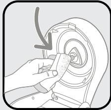
Falls Sie bemerken, dass die Pumpe im Standby-Betrieb unregelmäßig oder häufiger als üblich anläuft, kann es sein, dass das Dichtventil verschmutzt ist. Das Problem lässt sich durch das Reinigen des Dichtventils oder bei starker Verschmutzung/Beschädigung durch das Ersetzen mit einem neuen Ventil beheben (ein Ersatzventil liegt der Original Verpackung bei).
