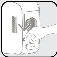
Den Stecker in eine Steckdose mit geeigneter Spannung einstecken und das Gerät durch Umstellen des An/Ausschalter auf „I“ einschalten.
