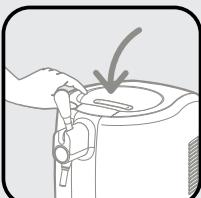
Помпата се задейства, когато капакът на уреда е затворен така, че да се осигури налягане, подходящо за наливане на бира.
