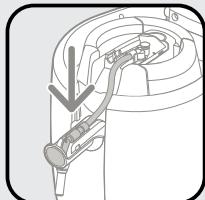
Posizionare il tubo per il passaggio della birra come mostrato nel disegno.
