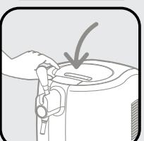
A szivattyú a készülék fedelének lezárása után várhatóan működni kezd, hogy biztosítsa a sör csapolásához szükséges nyomást.
