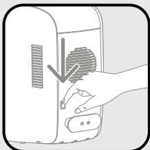
La tireuse à bière commencera immédiatement à refroidir la cuve dès que l'interrupteur marche/arrêt sera placé sur « I ».
