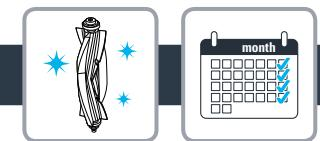
**CS** Jednou týdně vyčistěte následující části měkkým suchým hadříkem: nabíjecí destičky robota, senzory proti pádu, senzor vzdálenosti, nabíjecí destičky na dokovací stanici a přední kolo robota.
