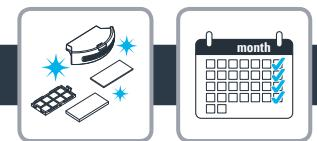
**PT** Limpe a grelha do filtro e o filtro, batendo ligeiramente na parte traseira por cima de um caixote do lixo.
