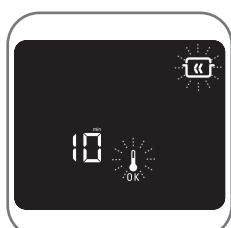
De même le motif **(W)** se met à clignoter dans l'écran pendant la phase de cuisson et devient fixe pendant la phase de maintien au chaud. Il est possible d'utiliser le mode maintien au chaud sans cuisson préalable (pour réchauffer des assiettes par exemple), dans ce cas appuyez sur la touche **(W)** quand le four est en veille.
