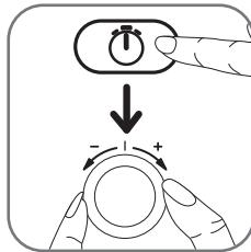
Appuyez sur la touche **()**. Réglez la durée de cuisson en tournant le sélecteur jusqu'à obtention du temps désiré. L'afficheur digital vous indique le temps en heures/minutes (ex. : 0:45).
