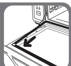
Replacez la vitre intérieure (marquages côté intérieur de la porte). Attention à bien positionner la vitre : les coins **arrondis doivent être en bas** (vers l'articulation de la porte). Engagez les coins supérieurs en 1<sup>er</sup> dans les encoches (voir les flèches).
