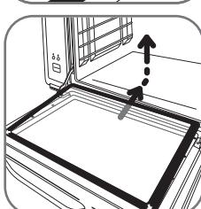
Die innere Scheibe sollte sich am unteren Ende selbst heben, damit sie sich besser greifen lässt. Schieben Sie sie in Richtung Ofeninneres, um sie aus den Halteaußsparungen zu entfernen.
