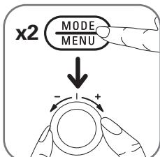
Sie haben zwei Zugriffsmöglichkeiten auf die Programmierung Ihres Backofens: Mit zweimaligem, schnellem Drücken der Taste wechseln Sie vom manuellen in den automatischen Betrieb und umgekehrt.
