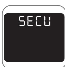
Deze functie is een aanvullende beveiling om te voorkomen dat kinderen de oven aanraken en/of bedienen. In de stand-by houdt de kinderbeveiliging de oven in stand-by zelfs wanneer de toetsen ingedrukt zijn of de draaiknop gedraaid is. Als de functie geactiveerd is tijdens de bereiding, kunt u geen instellingen wijzigen: om veiligheidsredenen behoudt alleen de toets **(STOP)** zijn functie om het kookproces te stoppen.
