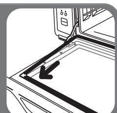
Plaats de binnenuit terug op zijn plaats (markeringen aan de binnenkant van de ovendeur). Let erop om de ruit goed te plaatsen: de **afgeronde hoeken moeten onderaan zijn** (naar het deurscharnier gericht). Plaats de bovenste hoeken het eerst in de gleuven (zie pijlen).
