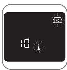
De aanwijzing gaat knipperen op het display tijdens het kookproces en wordt constant gedurende de automatische warmhoudfunctie. Het is mogelijk om de functie warmhoudfunctie zonder voorafgaand kookproces te gebruiken (bijvoorbeeld om bordjes op te warmen), druk in dit geval op de knop wanneer de oven op stand-by staat.
