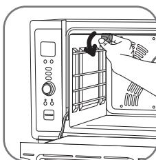
Pour remplacer l'ampoule :
